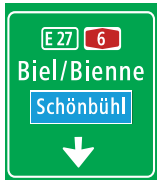
4.69 Einspurtafel über Fahrstreifen auf Autobahnen und Autostrassen
