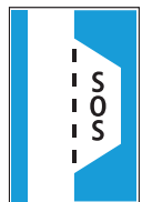
4.16 Abstellplatz für Pannfahrzeuge
