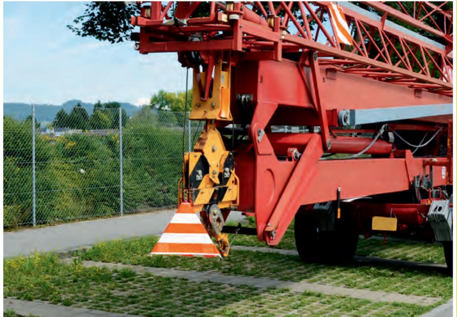
Mit Triopan Warn- und Gefahrensignalen lassen sich alle Arten von Transportgütern, welche ein Strassenfahrzeug überragen, gesetzeskonform absichern.
